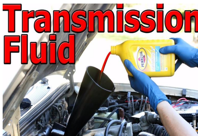
Рисунок 12 – Доливання трансмісійної рідини ATF під час технічного обслуговування автоматичної коробки передач
