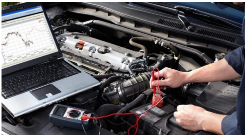
Рисунок 13 - Комп'ютерна діагностика автомобіля з використанням діагностичного обладнання
