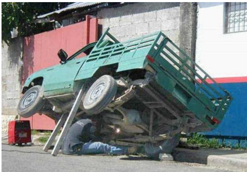
Рисунок 14 – Небезпечне встановлення автомобіля
