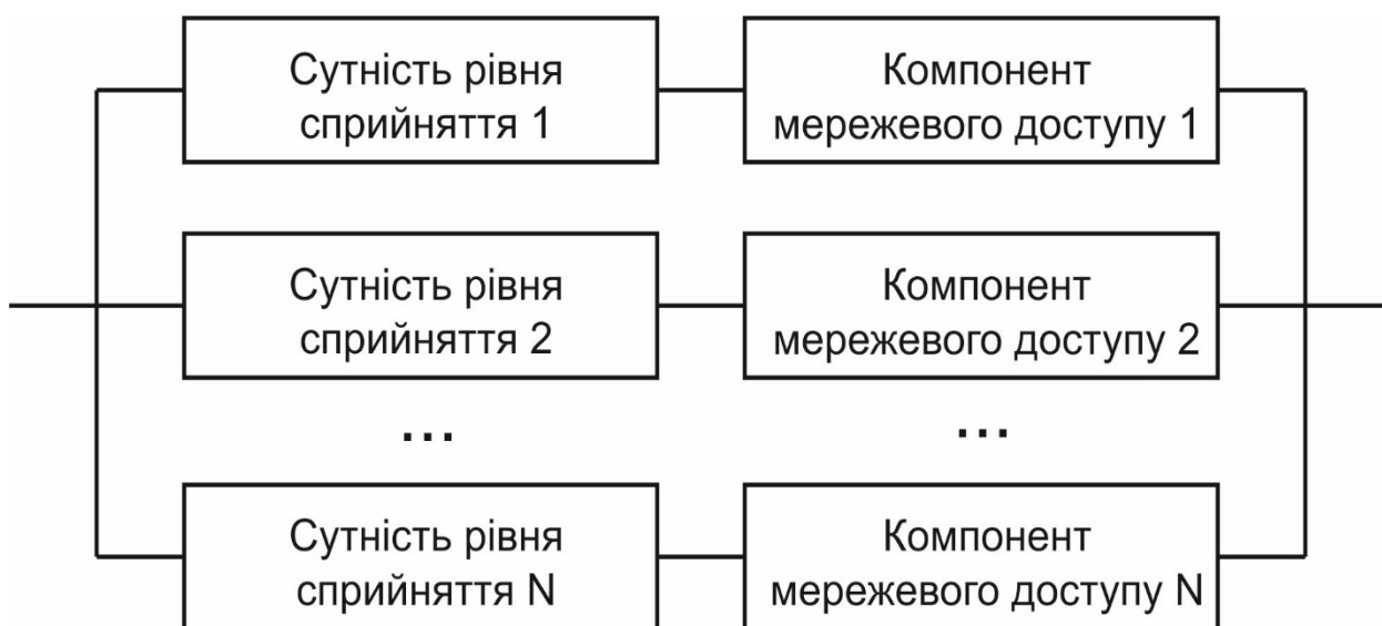
Рисунок 3.2 – Модель RBD (діаграма надійності) сутностей рівня сенсорних мереж
