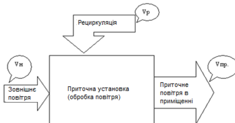
Рисунок 1.12 - Робота системи повітрообміну з рециркуляцією (рекуперацією)
