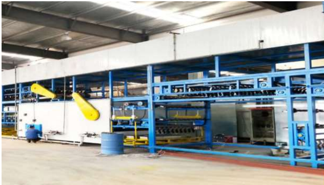
Рисунок 1.12 - Малогабаритна конвеєрна лінія для нанесення гумового покриття на рукавиці
