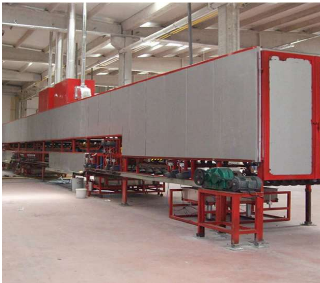
Рисунок 1.13 - Великогабаритна конвеєрна лінія для нанесення гумового покриття на рукавиці
