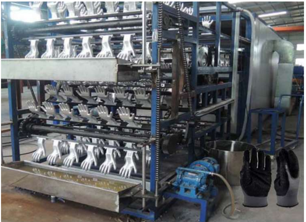
Рисунок 1.10 - Обладнання для виконання процесу нанесення гумового покриття на виріб
