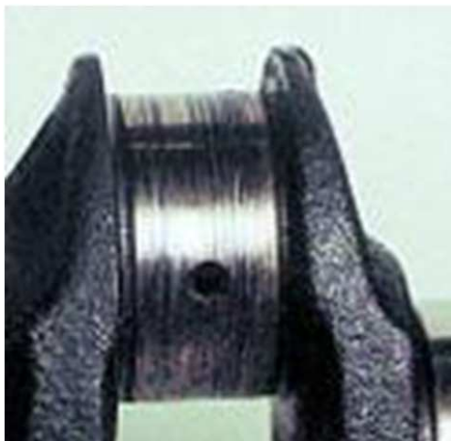
Рисунок 1.2 - Задир на шатунній шийці
