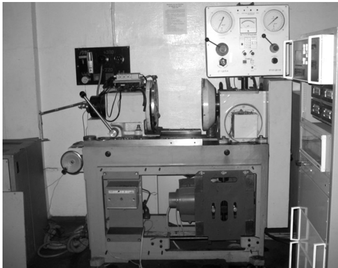
Рис. 2.13 – Загальний вигляд універсальної машини тертя УМТ-2168
