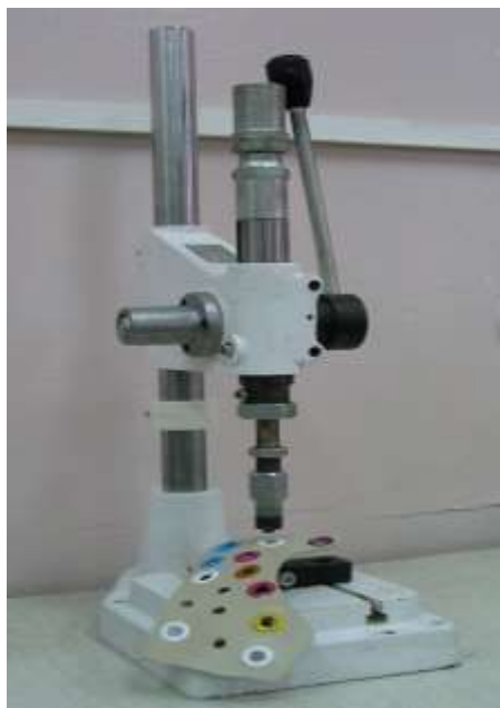
Рисунок 8 - Ручний механічний прес для встановлення металевої фурнітури
