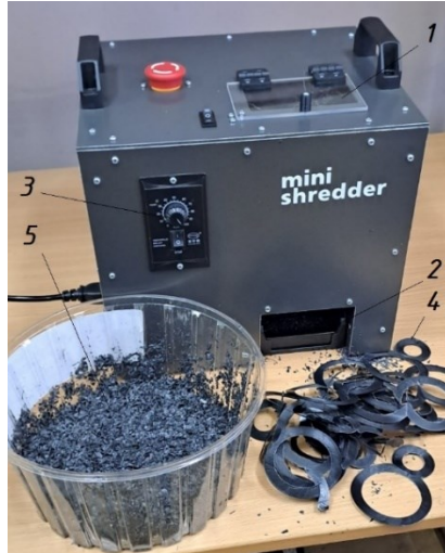
Рис.2 - Шредер для подрібнення полімерних відходів: 1-завантажувальний бункер; 2-контейнер для подрібнених часток полімеру; 3-регулятор частоти обертання подрібнюючого органу; 4-полімерний матеріал, що подрібнюється; 5-подрібнені частки полімеру
