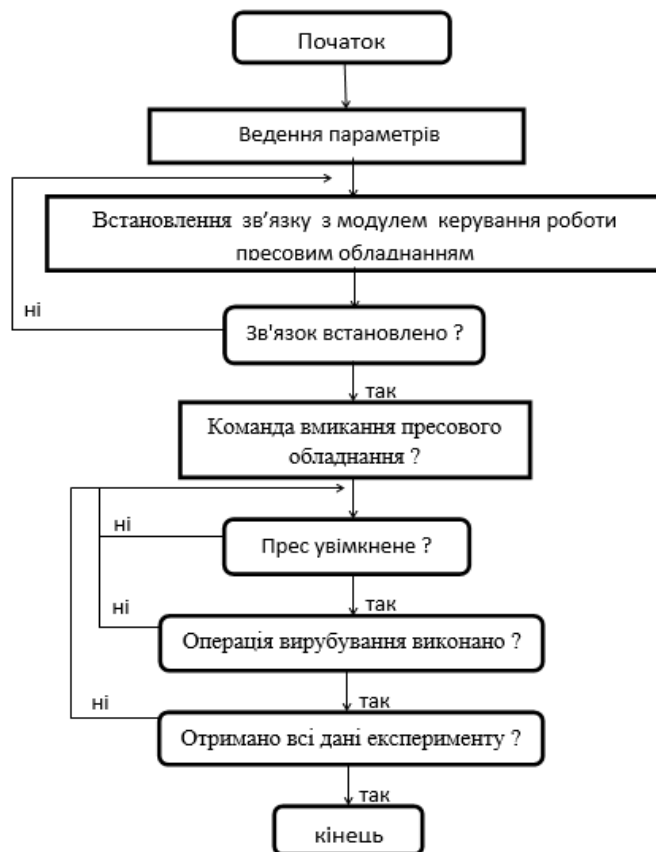
Рис.1 - Блок-схема алгоритму програми керування електрогідравлічним пресовим обладнанням
