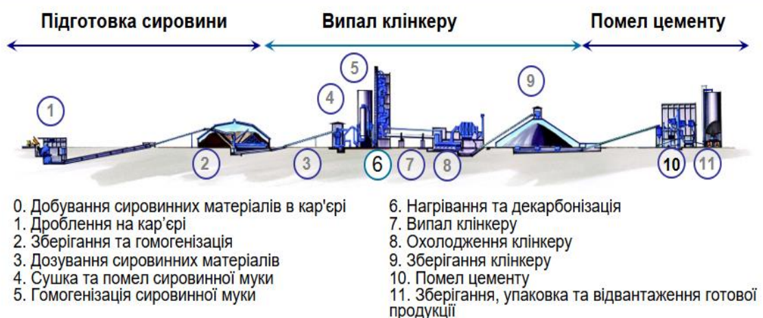
Рисунок 2.6 – Технологія виробництва клінкеру сухим способом
