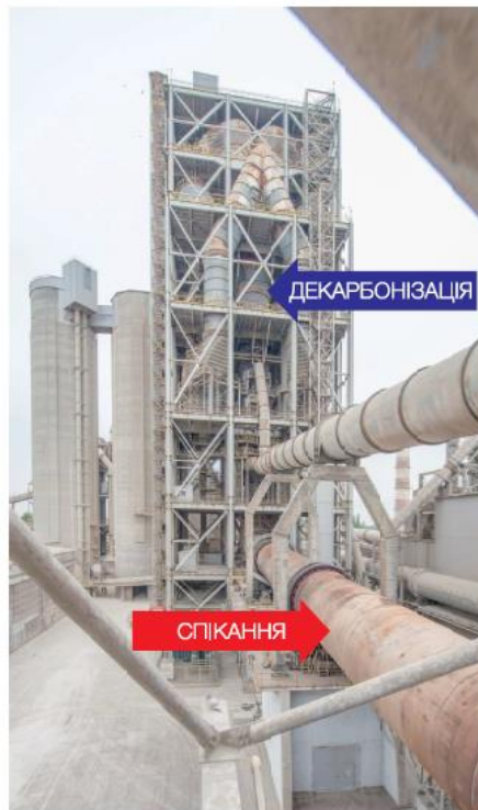
Рисунок 2.5 – Спікання та декарбонізація на АТ «Подільський цемент»
