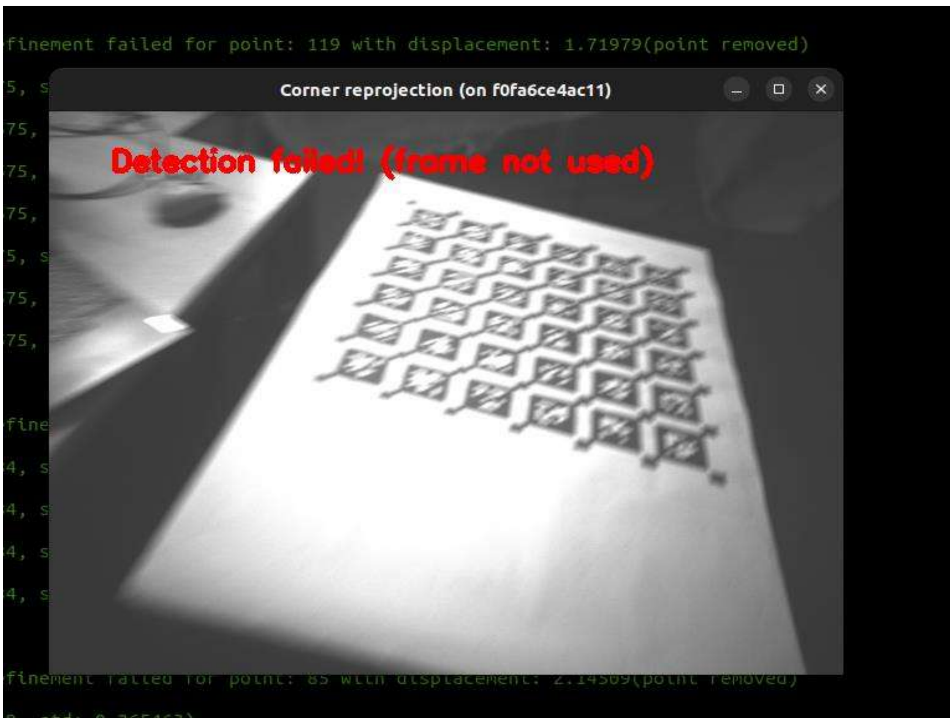
Рисунок 3.6 – Приклад діагностичного кадру Kalibr під час відбору калібрувальних зображень
