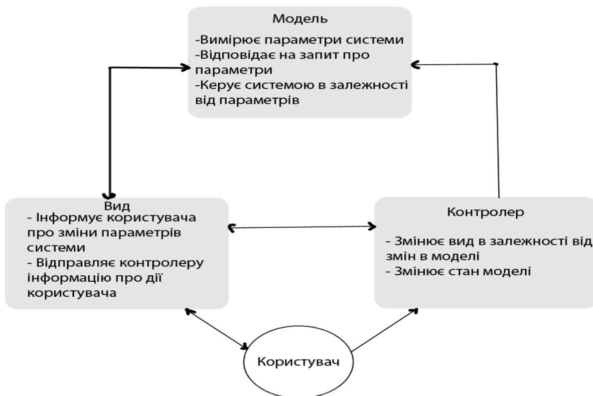
Рисунок 2.7 – MVC- модель системи автоматизації
