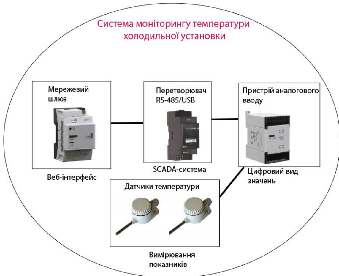
Рисунок 2.6 – Структурна схема системи моніторингу
