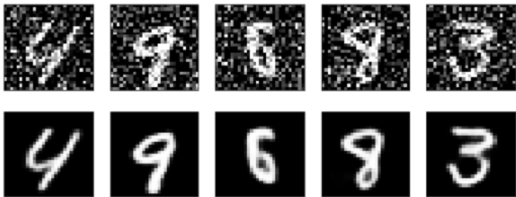
Рисунок 2.13 - Зашумлені входи (вгорі) разом із відповідними приглушеними прогнозами (внизу) згорткового автокодера
