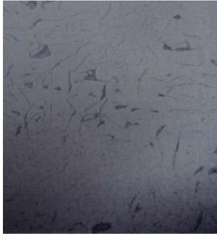
Рисунок 4.12 – Мікроструктура шару, зміцнення взаємодії з оксидом хрому, x 400
