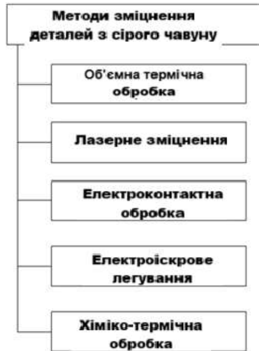
Рисунок 1.16 – Методи зміцнення деталей із сірого чавуну
