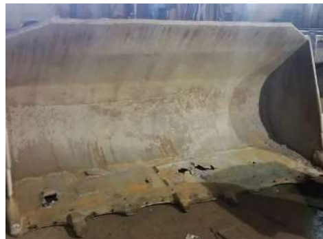
Рисунок 5.7 – Ківш мінівантажувача Termit 1000 без зносостійких елементів через 2 місяці роботи
