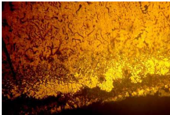
Рисунок 4.13 – Мікроструктура шару після взаємодії з оксидом титану, x100
