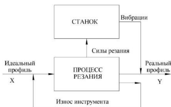
Рисунок 2.9 Блок-схема утворення мікронерівностей при токарній обробці
