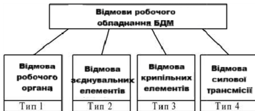
Рисунок 2.1 – Класифікація відмов робочого устаткування
