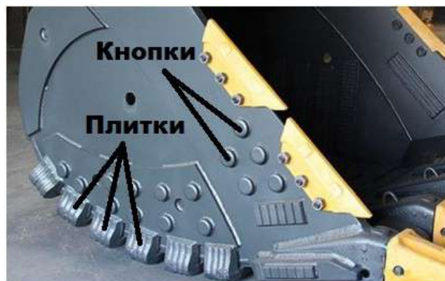
Рисунок 1.15 – Захист ковша екскаватора
