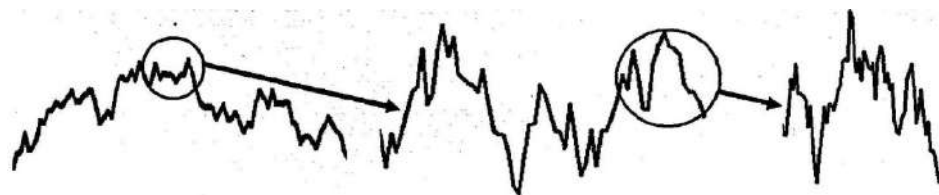
Рисунок 2.11 – Самоафінність профілю шорсткості поверхні
