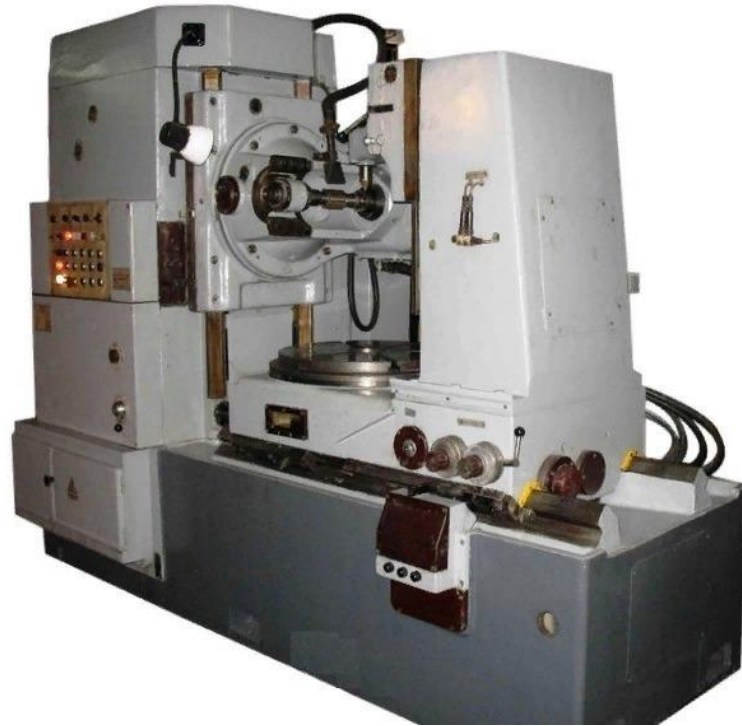
Рисунок 3.4 – Верстат зубофрезерний вертикальний напівавтомат 5Е32
