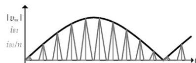
Рис. 5 – Зміна вхідного та вихідного струмів подвійного активного моста з випрямленою вхідною напругою
