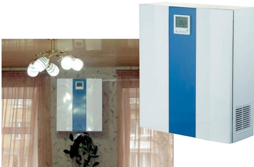
Рисунок 3.4.1 - Установка серии Мікра 150 (настінний варіант монтажу) продуктивністю 20–150 м 3 /год з пластинчастим рекуператором (ефективність до 75 %) та позисторним нагрівачем 350 Вт. [7]
