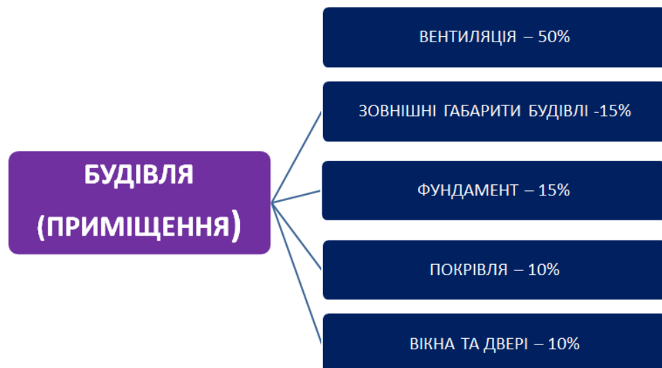
Рисунок 1.1 – Можливі втрати теплоти в будівлі
