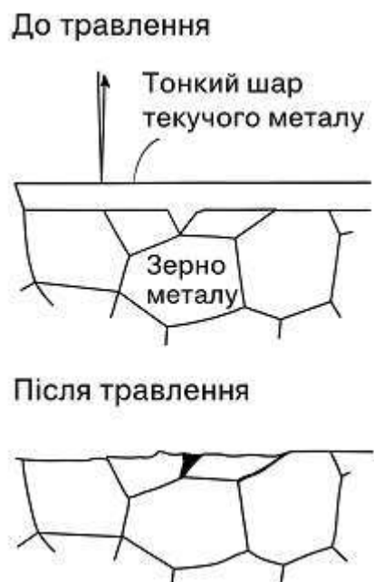
Рисунок 2.3 – Схема що пояснює зображення поверхні мікрошліфа, яке спостерігається під мікроскопом «до травлення» та «після травлення».
