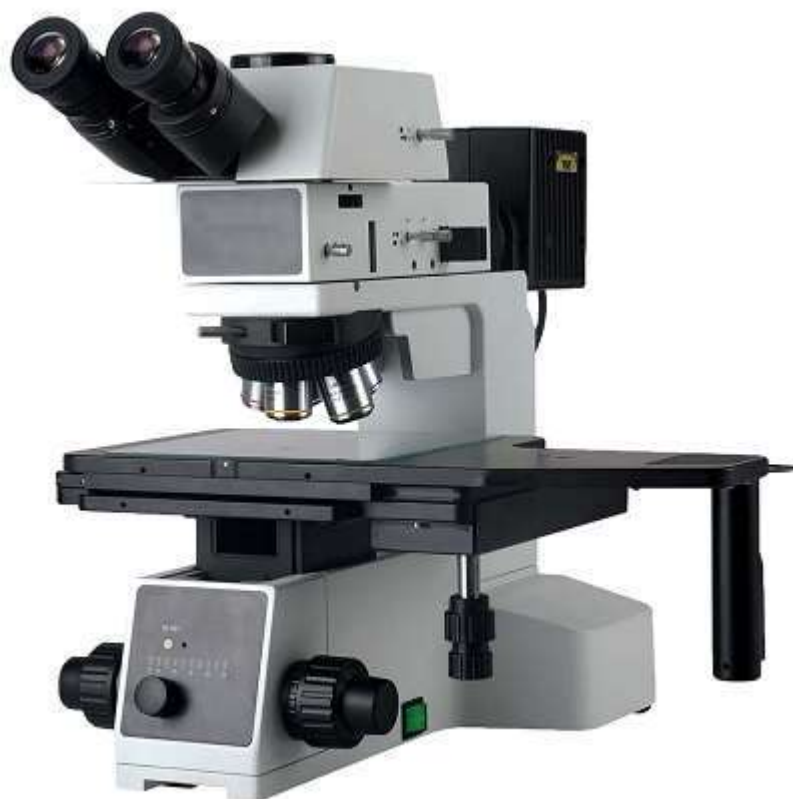
Рисунок 2.7 – Металографічний мікроскоп модель Fein Optic M46 для відбитого/пропущеного світла та матеріалознавчих досліджень
