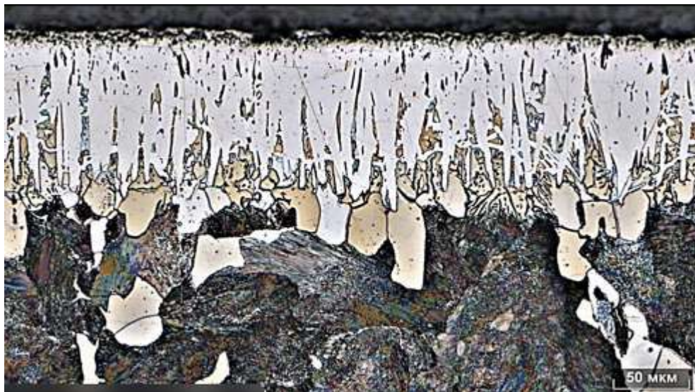
Рисунок 3.12 – Мікроструктура сталі 45 титанування: T = 950\text{ }^{\circ}\text{C} , \tau = 2\text{ год.} На рисунку 3.12 представлено поперечний шліф сталі AISI 1045 (аналог – сталь 45) після дифузійного насичення титаном. Структура демонструє чітко виражений поверхневий шар карбиду титану (TiC), який проявляється як світла,
