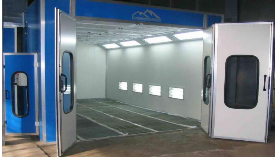
Рисунок 3.10 Фарбувальна камера стандартних розмірів 7x4x2.8
