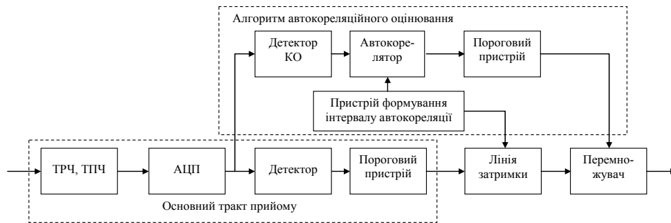
Рис. 1. Структурна схема приймача РЛС, що реалізує запропонований метод
