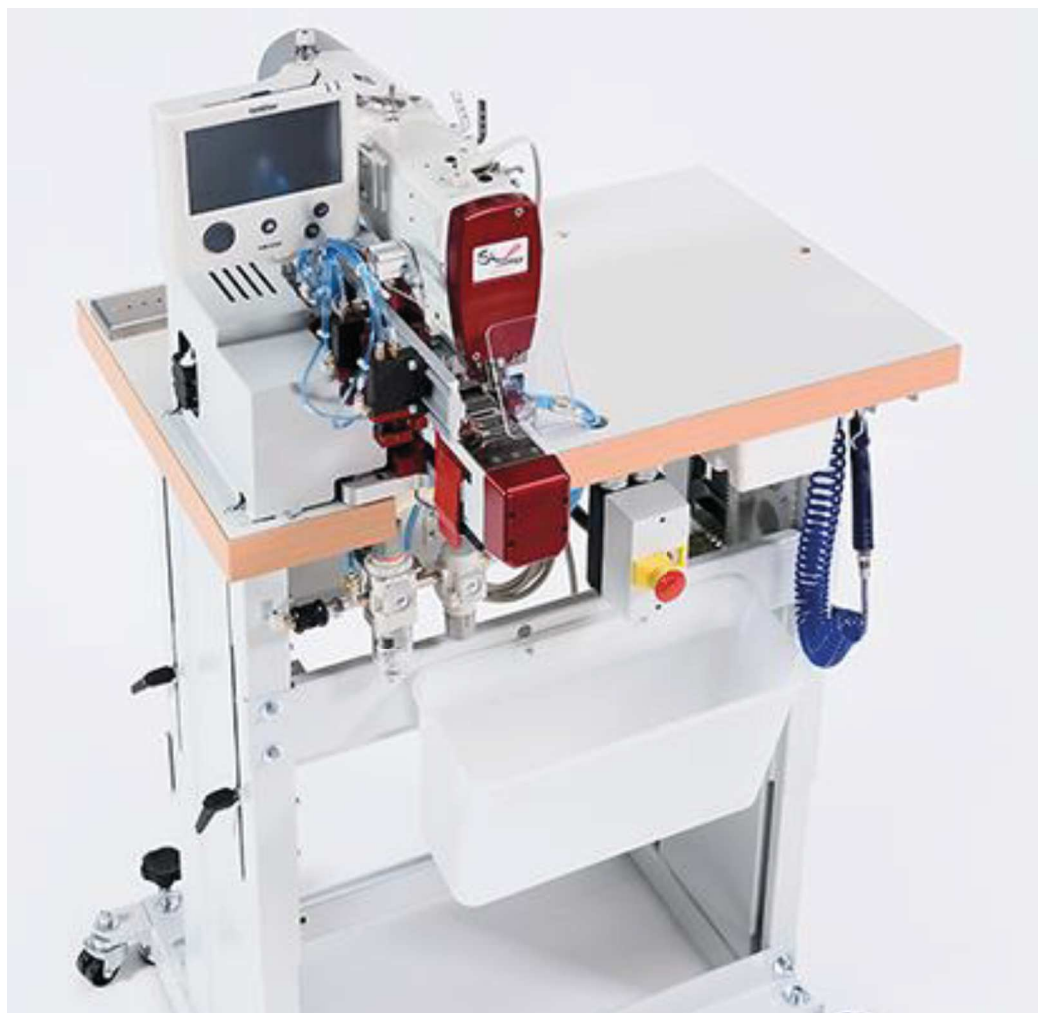
Рисунок 1.11 – Автоматична робоча станція на базі двоголкової машини Brother для приточування хомутиків
