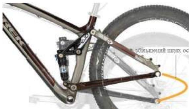
Рисунок 1.8 – Підвіска Active Braking Pivot (активне гальмування).
