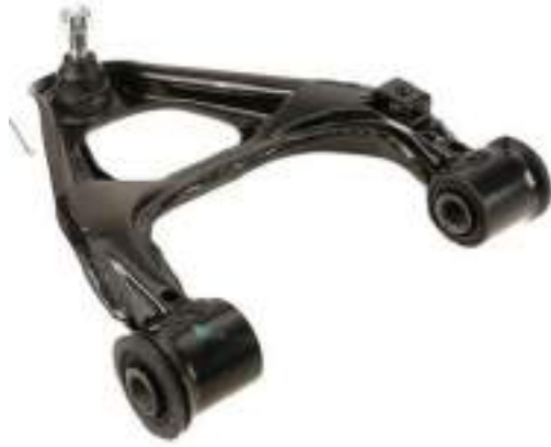
Рисунок 1.10 – Трикутний важіль підвіски.
