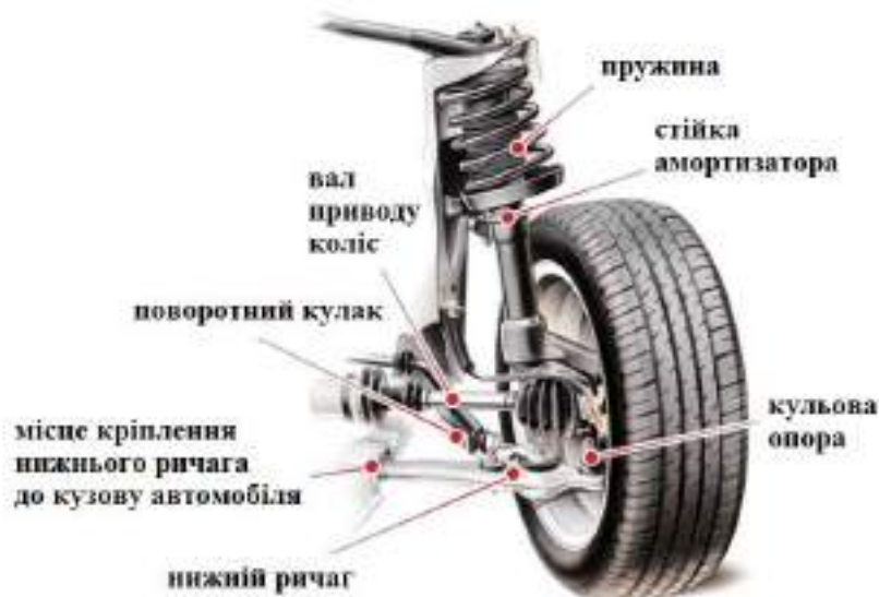
Рисунок 1.14 – Система підвіски Макферсон [10].
