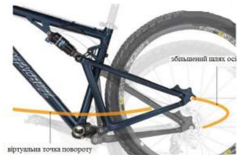
Рисунок 1.5 – Дволанкова чотири важільна система.
