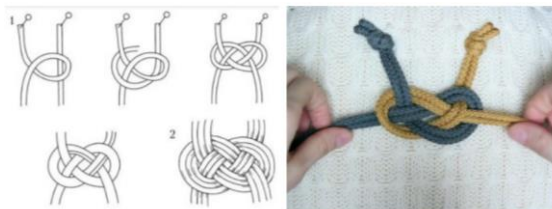
Рисунок 1.2.19 – Поетапне виконання вузла «Жозефіна»
