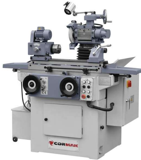
Рисунок 2.5 – круглошліфувальний верстат моделі CORMAK USM5000
