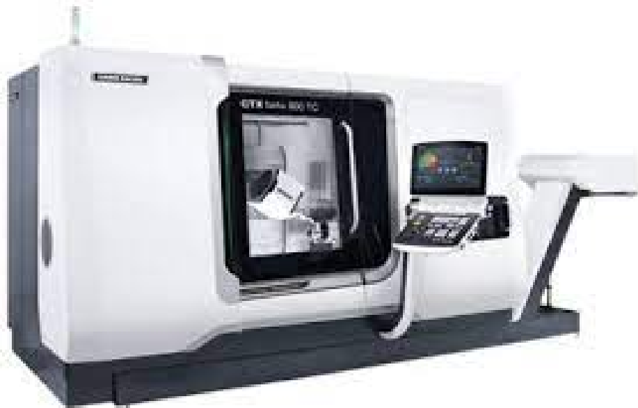
Рисунок 2.3 – токарний з ЧПУ верстат DMG STX 310
