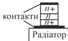
Рисунок 1.10 – Структура діода Ганна
