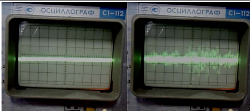
Рис. 8. Осцилограми сигналу з детектора електромагнітного поля до (а) та в процесі (б) руйнування чавунного зразка на гідравлічному пресі
