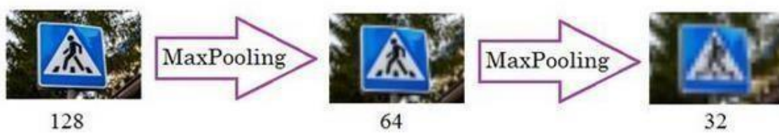
Рисунок 2.6 – Приклади зображення при використанні max pooling [47]
