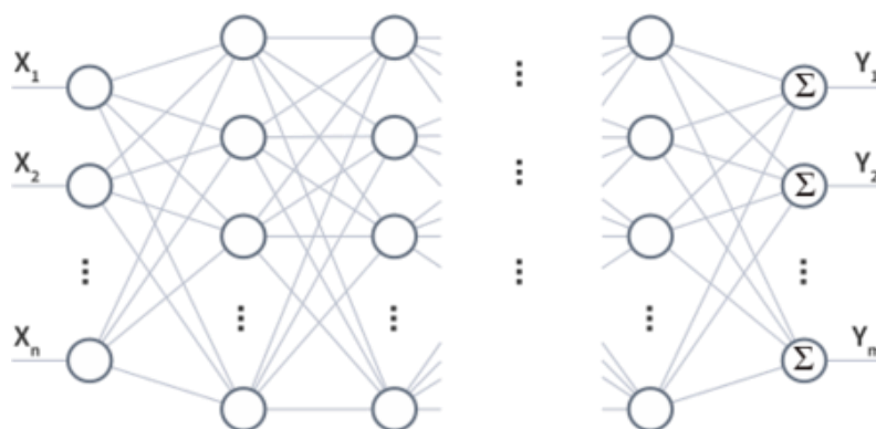
Рисунок 2.1 – Загальний вигляд структури перцептрону [26]
