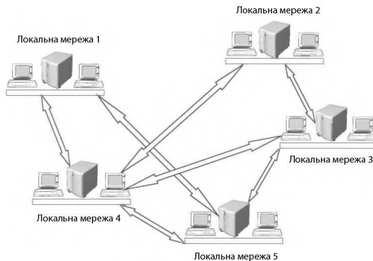
Рисунок 2.5 - Мережа з сітчастою топологією
