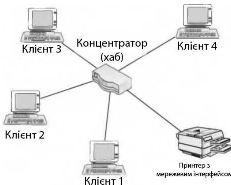
Рисунок 2.3 - Мережа з топологією «зірка-шина»
