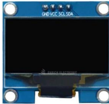
Рисунок 2.5 – 1.3-дюймовий модуль OLED дисплею
