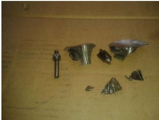
Рис.4.4 – Осколки робочого колеса компресора та кінцевик ротора.
