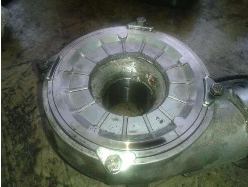
Рис.4.3 - Зруйнований повітропровід компресорної частини.
