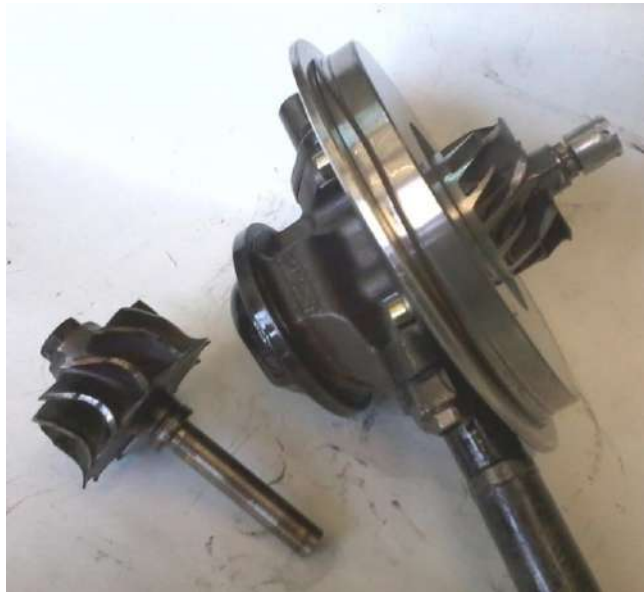
Рис. 4.14 – Турбокомпресор ТКР-80 після випробувань із демонтованими повітроводами.
