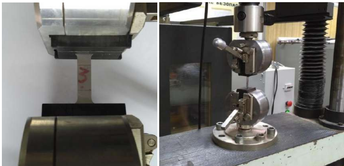
Рис.4.8 – Схема закріплення дослідного зразка у випробувальній машині.
