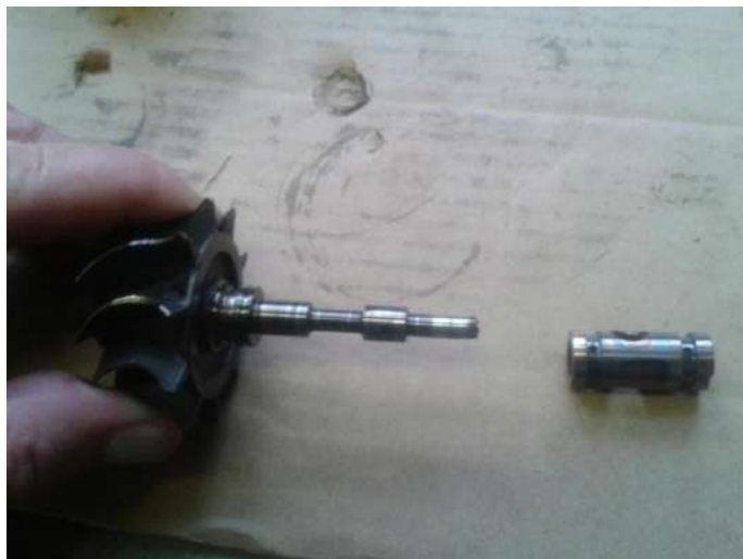
Рис.4.5 – Демонтований фрагмент ротора та моновтулка підшипника.
