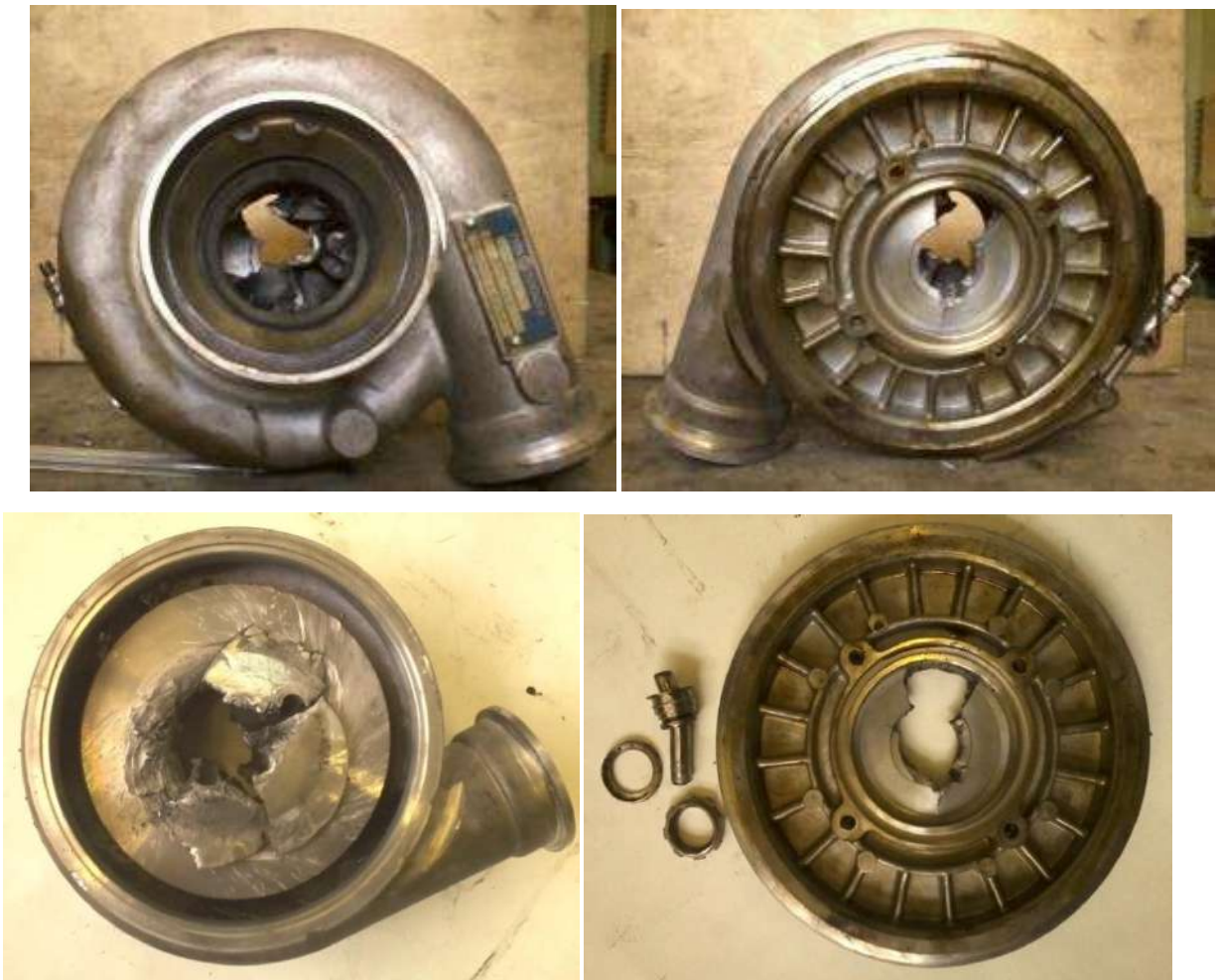
Рис.4.6 – Демонтована компресорна частина ТКР-80 з уламками колеса та кінцевиком ротора.
