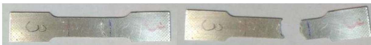
Рис.4.9 – Фотографія дослідного зразка №3.1 (зразок, вирізаний із третьої заготовки РК) до та після руйнування.
