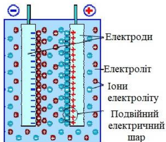
Рисунок 2.5 – Принцип роботи конденсатора з подвійним електричним шаром
