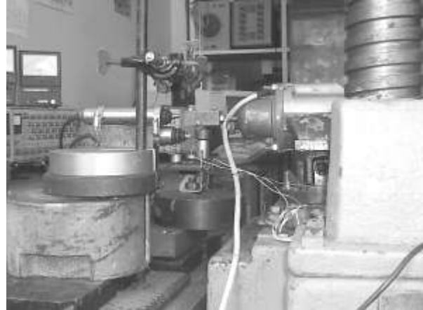
Рис. 1 – Принципова схема і вигляд установки для дослідження фретингостійкості азотованих шарів
