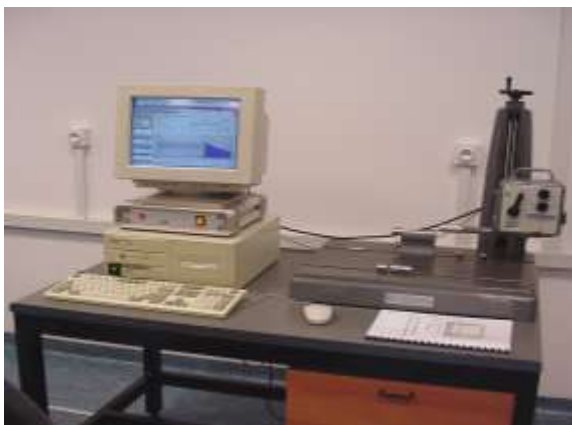
Рис. 2 – Профілограф-профілометр TALYSURE 4 (а), протокол вимірювання мікрогеометрії поверхні (б)
