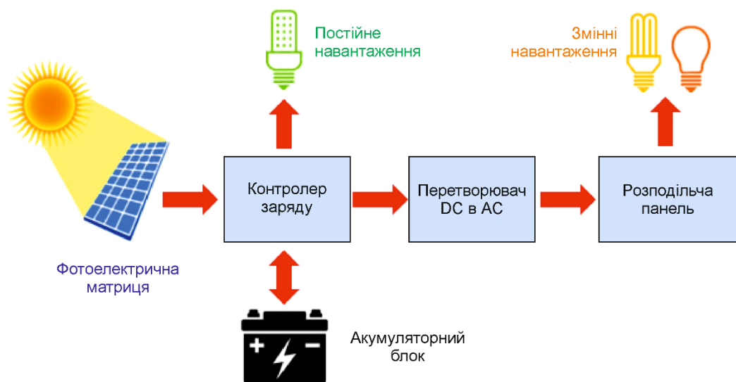
Рисунок 1 – Блок-схема типової автономної фотоелектричної системи
