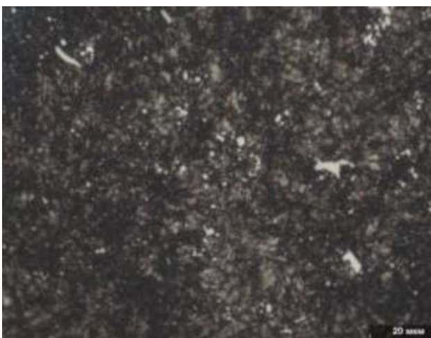
Рисунок 3.13 – Мікроструктура кульки підшипника №1 (x1000)
