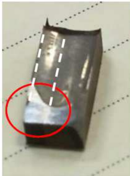
Рисунок 3.6 – Зразок з точеною поверхнею для підготовки косого шліфу
