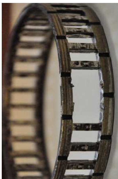
Рисунок 1.6 – Сепаратор міжроторного підшипника
