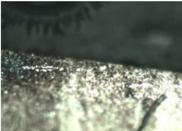
Рисунок 3.26 – Мікроструктура зовнішньої обойми (з боку неробочої поверхні) підшипника № 2 (x500)
