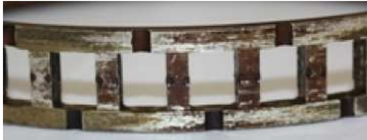
Рисунок 1.11 – Сепаратор МРП зі слідами нерівномірного зносу
