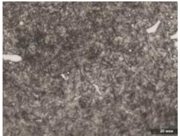
Рисунок 3.12 – Мікроструктура зовнішньої обойми підшипника № 1 (x1000)
