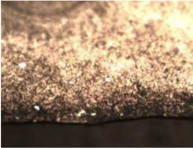
Рисунок 3.9 – Мікроструктура зовнішньої обойми підшипника №1 (x500)
