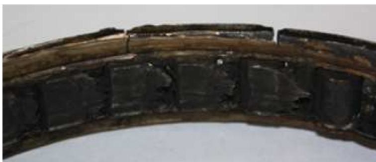
Рисунок 1.10 – Сепаратор відмовився у польоті МРП
