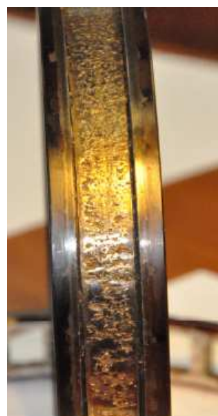
Рисунок 1.7 – Внутрішнє кільце міжроторного підшипника
