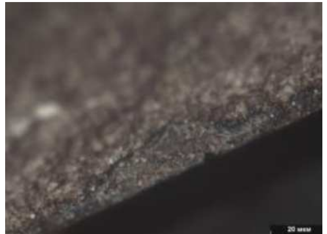
Рисунок 3.23 – Мікроструктура зовнішньої обойми (робочої поверхні) підшипника №2 (x1000)
