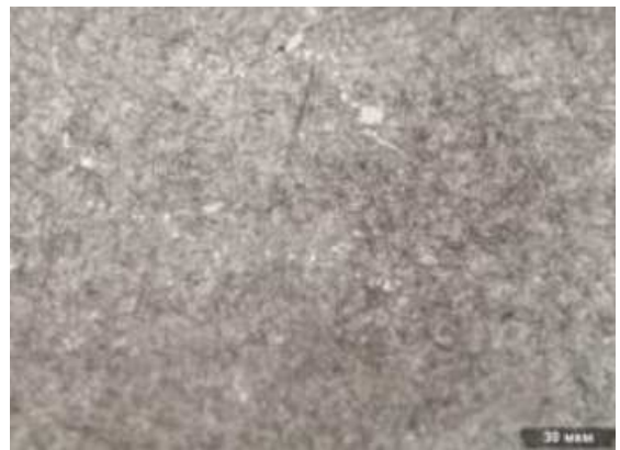
Рисунок 3.29 - Мікроструктура зовнішньої обойми (центральної частини) підшипника №2 (x500)
