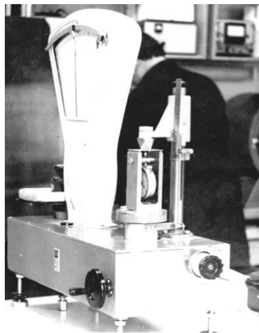
Рис. 4.2 - Машина МІП–10–1 з пристосуванням для навантаження і вимірювання прогину пластини
