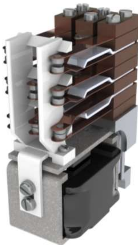
Рисунок 3.1 – Модель реле отримана в Solid Works
