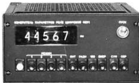
Рисунок 1.5 – Стенд “Вимірювач параметрів реле цифровий Ф291”
