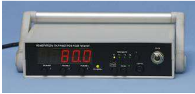
Рисунок 1.4 – “Вимірювач параметрів реле СНІ 2400”
