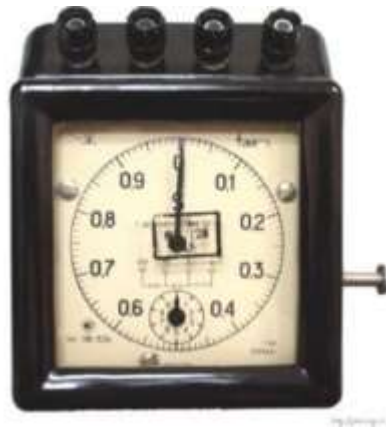
Рисунок 1.3 – Секундомір електричний лабораторний ПВ 53
