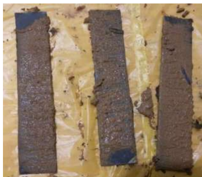
Рисунок 3.25 – Фото зразків із графітом після взаємодії із сирією глиною (а) та після впливу потоку повітря при температурі +20°C (б)
