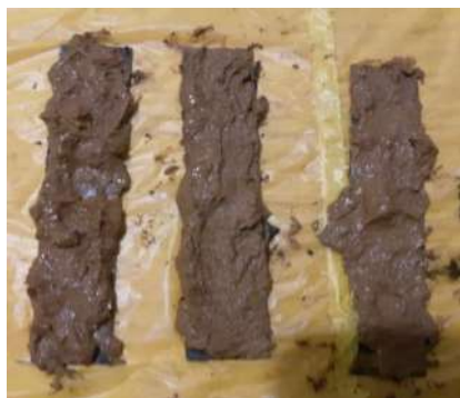
Рисунок 3.25 – Фото зразків із графітом після взаємодії із сирією глиною (а) та після впливу потоку повітря при температурі +20°C (б)
