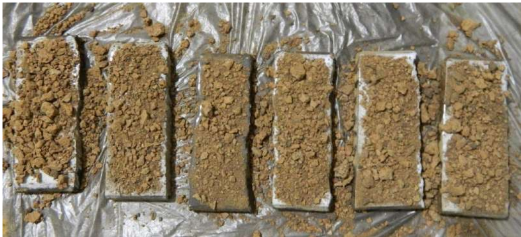
Рисунок 3.8 – Фото зразків після взаємодії з піском (а) та після впливу потоку повітря при температурі +20°C (б)
