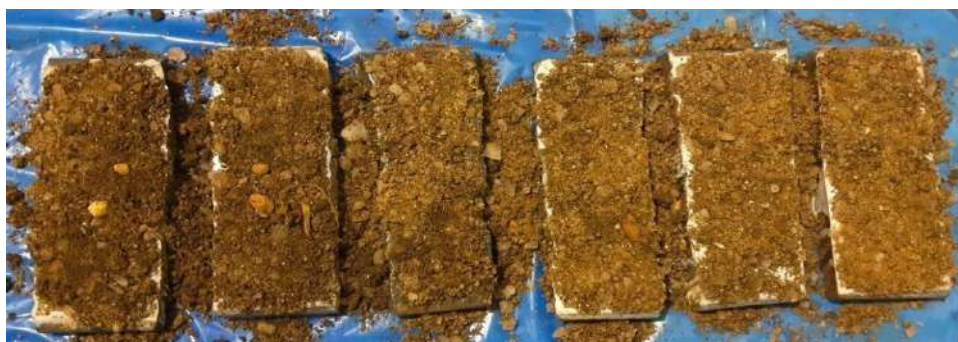
Рисунок 3.13 – Фото зразків після взаємодії з сирою ґрунтовою сумішшю, змішаною з протиожеледним реагентом
