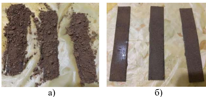
Рисунок 3.24 – Фото зразків із графітом після взаємодії із сухою глиною (а) та після впливу потоку повітря при температурі +20°C (б)
