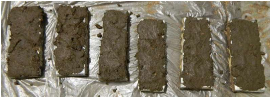
Рисунок 3.11 – Фото зразків після взаємодії із сухою ґрунтовою сумішшю до (а) та після впливу потоку повітря при температурі +20°C (б)
