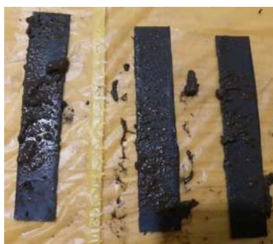
Рисунок 3.27 – Фото зразків з графітом після взаємодії з сирією ґрунтовою сумішшю (а) та після впливу потоку повітря при температурі +20°C (б)
