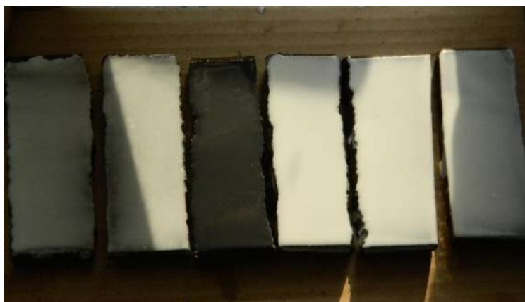
Рисунок 3.1 – Зовнішній вигляд зразків після нанесення покриттів із різними наповнювачами
