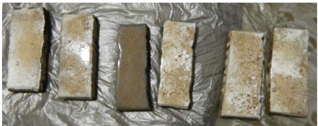
Рисунок 3.9 – Фото зразків після взаємодії із сухою глиною (а) та після впливу потоку повітря при температурі +20°C (б)
