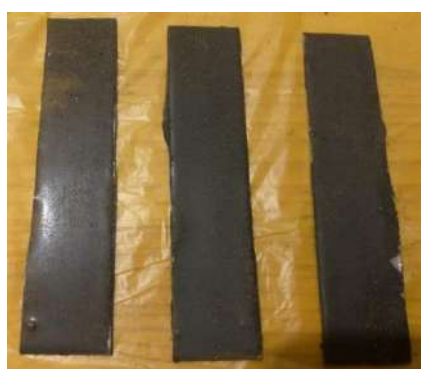
Рисунок 3.26 – Фото зразків з графітом після взаємодії із сухою ґрунтовою сумішшю (а) та після впливу потоку повітря при температурі +20°C (б)
