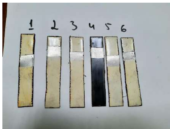
Рисунок 3.34 – Зразки після зрізу ділянки полімерного покриття з металевої підкладки
