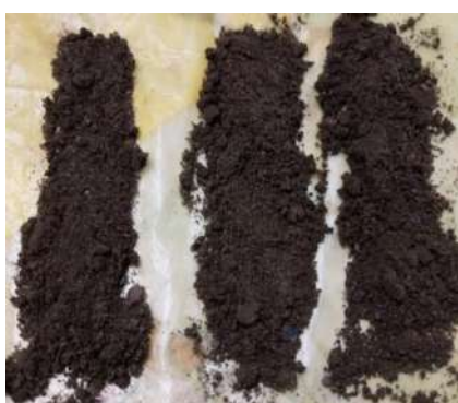
Рисунок 3.26 – Фото зразків з графітом після взаємодії із сухою ґрунтовою сумішшю (а) та після впливу потоку повітря при температурі +20°C (б)
