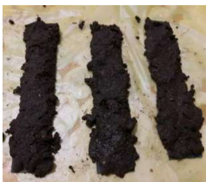
Рисунок 3.27 – Фото зразків з графітом після взаємодії з сирією ґрунтовою сумішшю (а) та після впливу потоку повітря при температурі +20°C (б)
