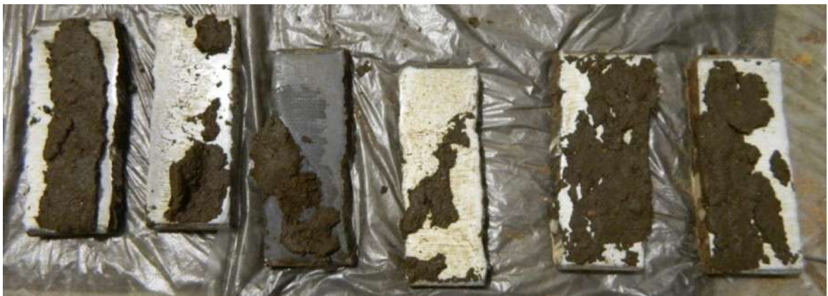
Рисунок 3.12 – Фото зразків після взаємодії з сирою ґрунтовою сумішшю до (а) та після впливу потоку повітря при температурі +20°C (б)
