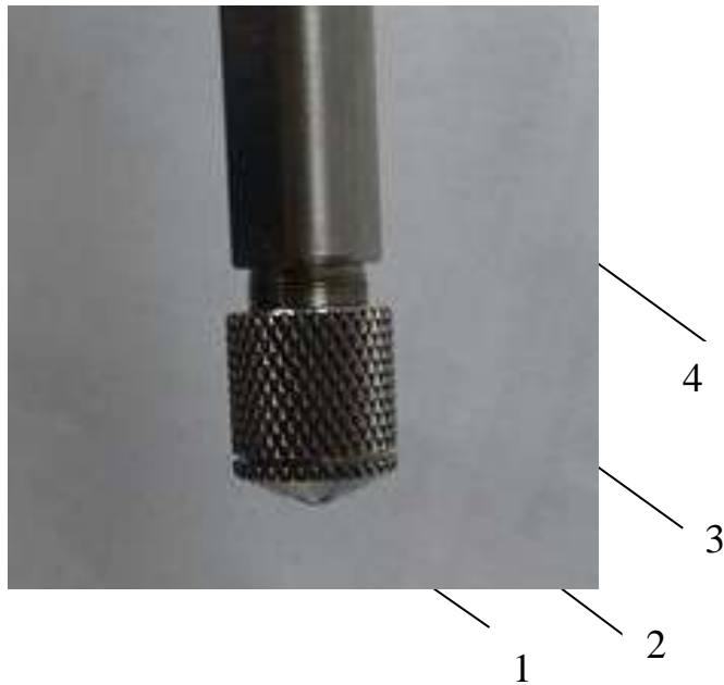
Рисунок 4.2 – Фото елемента пристосування машини Nanovea Tribometer: 1 – кулька; 2 – втулка; 3 – різьбове з'єднання; 4 – шпиндель
