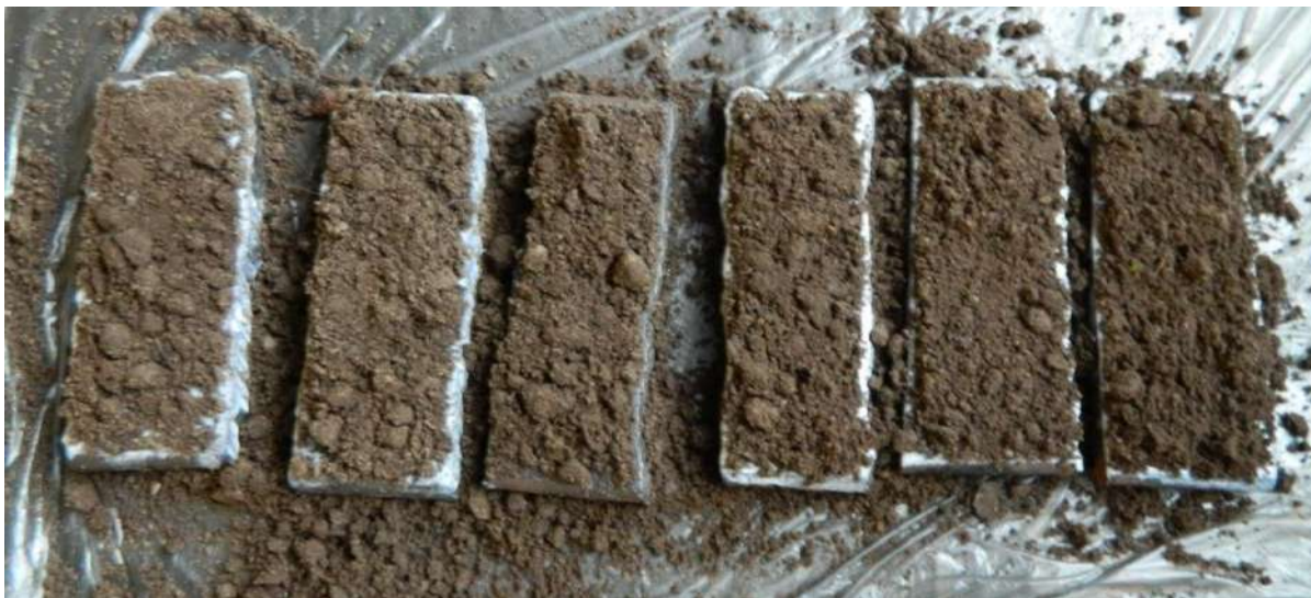
Рисунок 3.10 – Фото зразків після взаємодії із сирію глиною (а) та після впливу потоку повітря при температурі +20°C (б)
