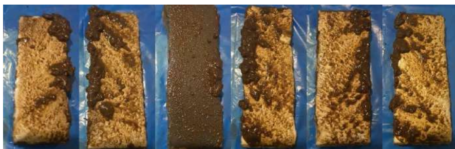
Рисунок 3.13 – Фото зразків після взаємодії з сирою ґрунтовою сумішшю, змішаною з протиожеледним реагентом
