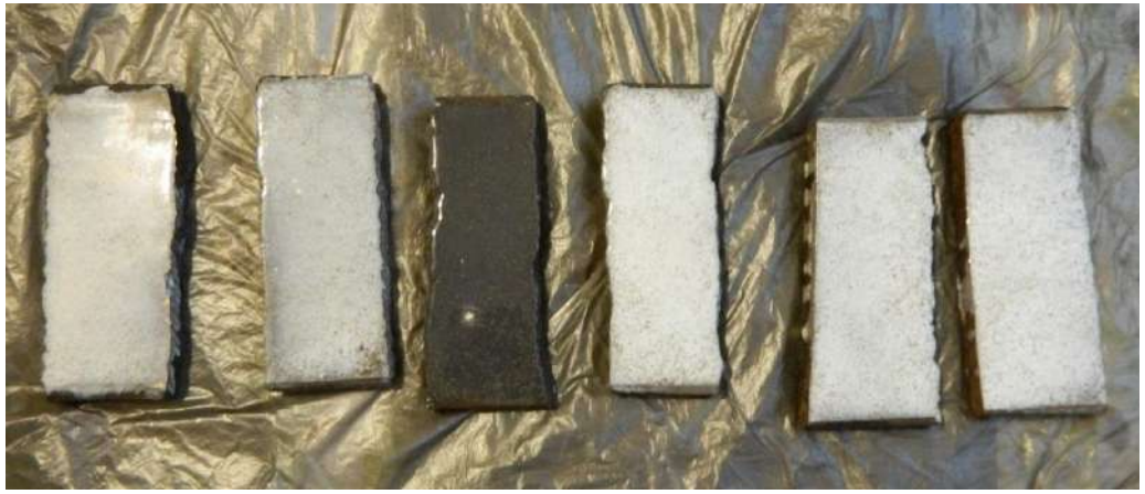
Рисунок 3.11 – Фото зразків після взаємодії із сухою ґрунтовою сумішшю до (а) та після впливу потоку повітря при температурі +20°C (б)
