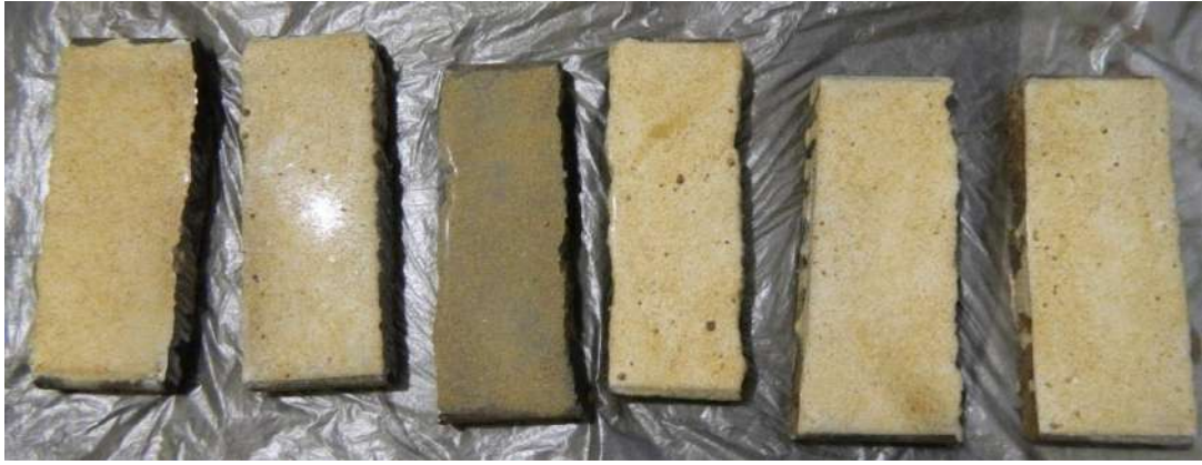
Рисунок 3.8 – Фото зразків після взаємодії з піском (а) та після впливу потоку повітря при температурі +20°C (б)
