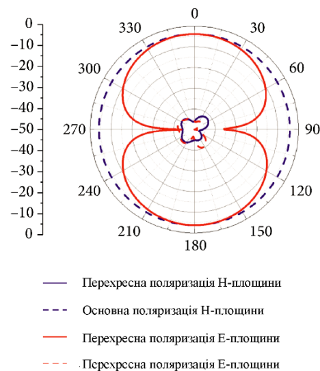
Рисунок 4.13 – Змодельована перехресна поляризація в площині Е та Н на частоті 1,74 ГГц
