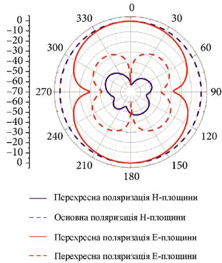
Рисунок 4.14 – Змодельована перехресна поляризація в площині Е та Н на частоті 3,68 ГГц
