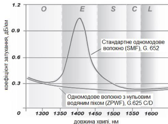
Рисунок 1.2 – Розподіл довжин хвиль за спектральними діапазонами, відповідно до G.694.2
