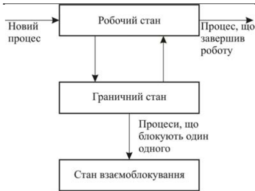
Рис. 2. Схема переходу процесів у стан взаємоблокування
