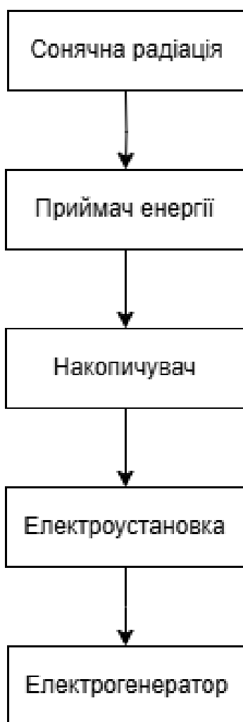
Рисунок 1.2 – Схема сонячної теплоелектростанції
