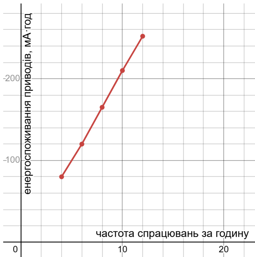
Рисунок 4.6 – Залежність споживання від частоти обертання приводів
