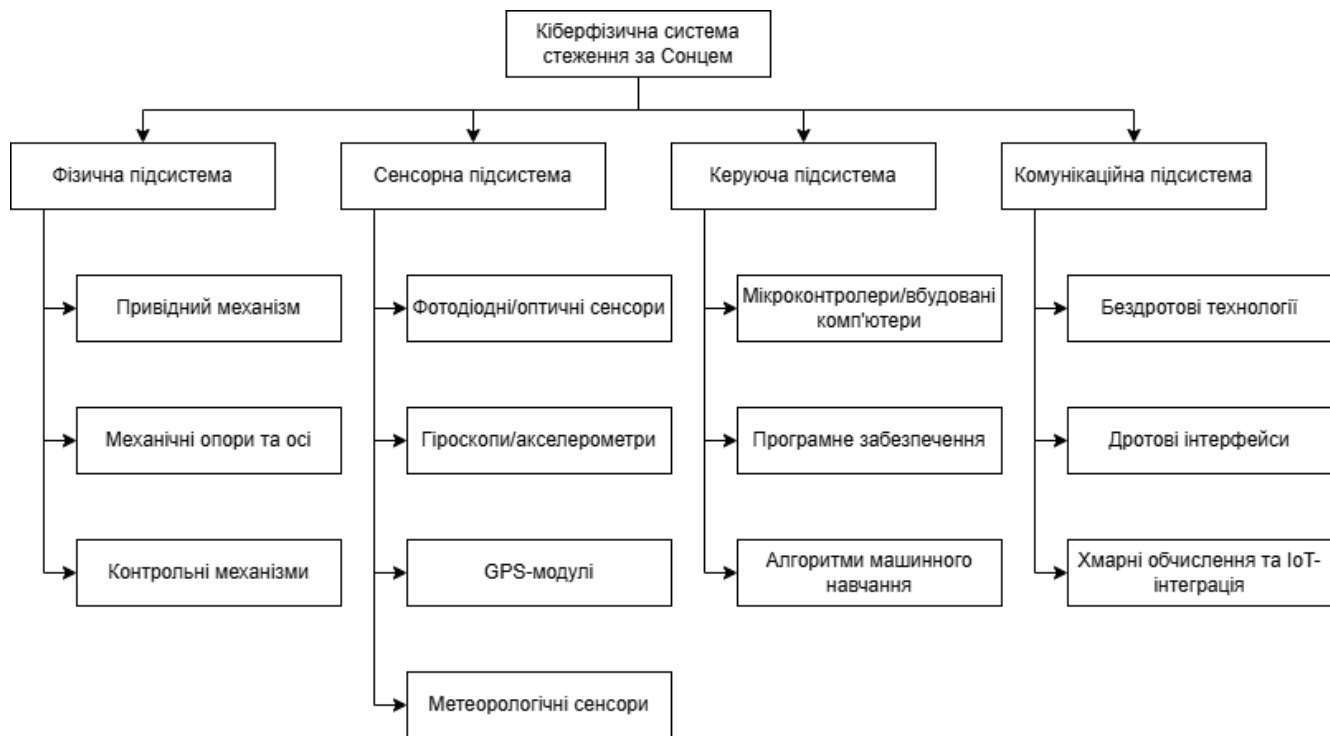
Рисунок 2.2 – Схема кіберфізичної системи стеження за Сонцем
