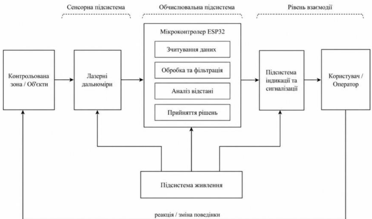
Рисунок 2.1 – Загальна архітектура мікроконтролерної кіберфізичної системи позиціонування та виявлення об'єктів
