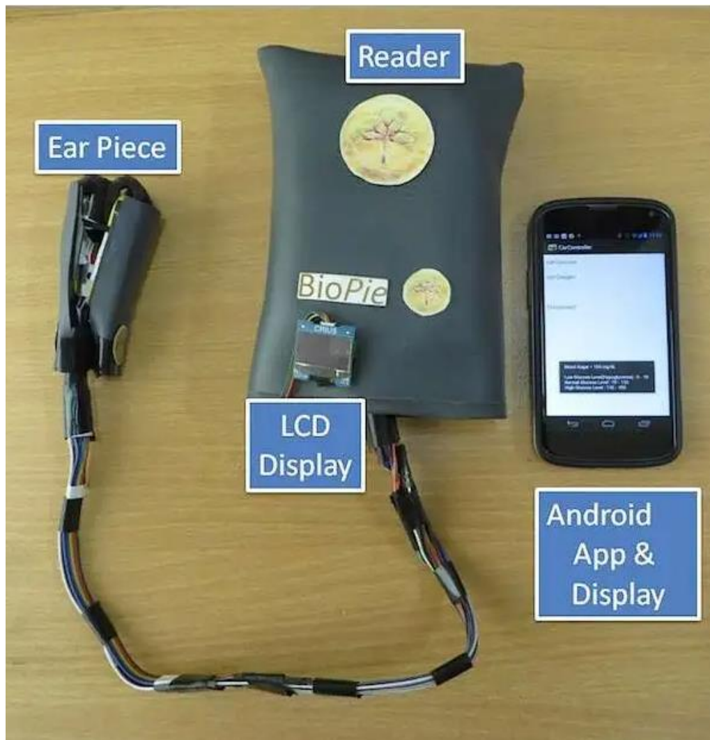
Рисунок 1.3 – Неінвазивна глюкозо-моніторингова система на основі спектроскопії ближнього інфрачервоного (NIR)
