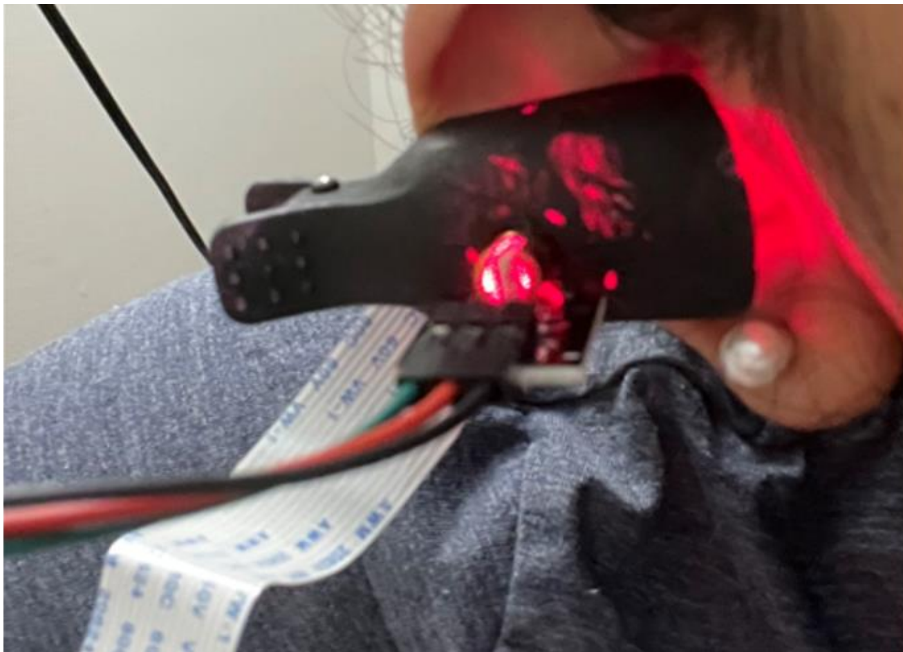
Рисунок 3.1 – Мобільна кіберфізична система GlucoWise
