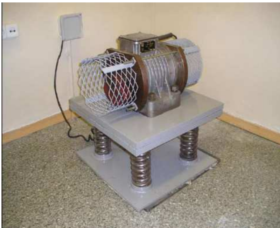
Рисунок 3.12 – Стенд для дослідження довговічності при циклічному навантаженні посадок підшипників на базі електромеханічного вібратора ІВ-107А
