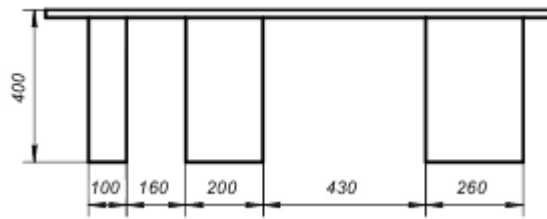
Рисунок 4.1 – Вигляд виробу спереду, разом з відповідними розмірами в мм
