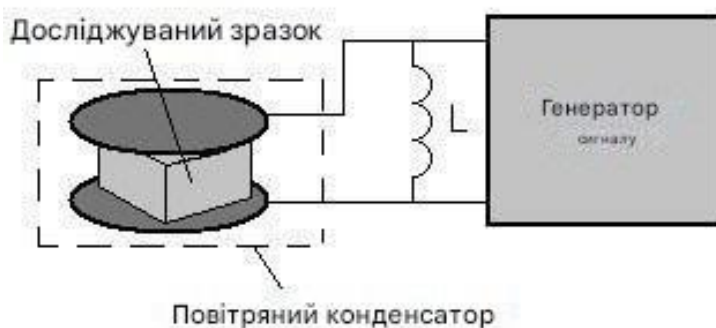
Рисунок 2.9 - Структура ємнісного типу датчика вологості з повітряним діелектриком
