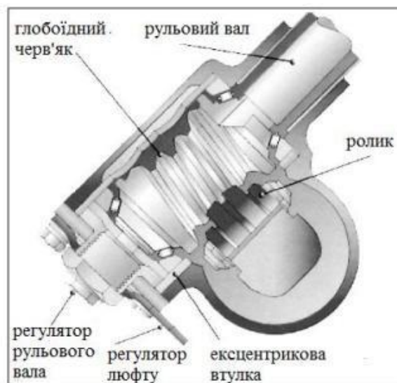
Рисунок 7 – Черв'ячно-роликовий рульовий механізм
