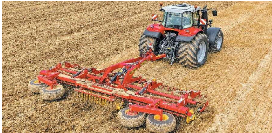
Рисунок 1.2 - Багатофункціональний дисковий агрегат Carrier фірми Väderstad на обробітку стерні [4].
