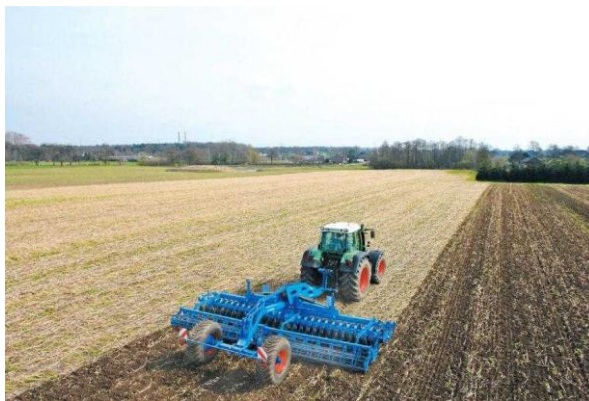
Рисунок 1.3 - Борона Heliodor 9 компанії Lemken в роботі [4].
