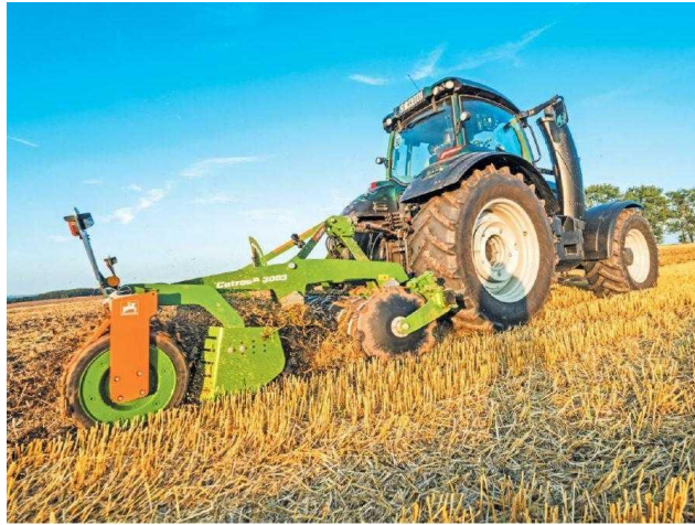
Рисунок 1.6 – Навісна дискова борона Catros із вирізними дисками фірми Amazone [4].
