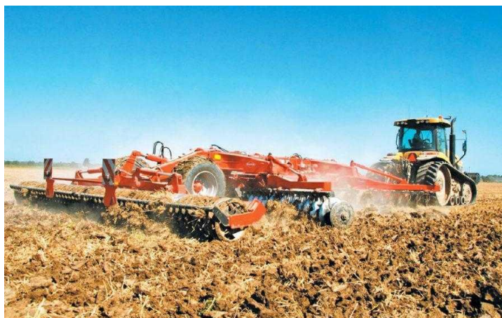
Рисунок 1.4 - Борона Discover XL фірми Kuhn [4].
