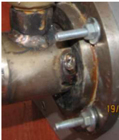
Рисунок 3.4 – Кріплення нагрівальної частини на установці
