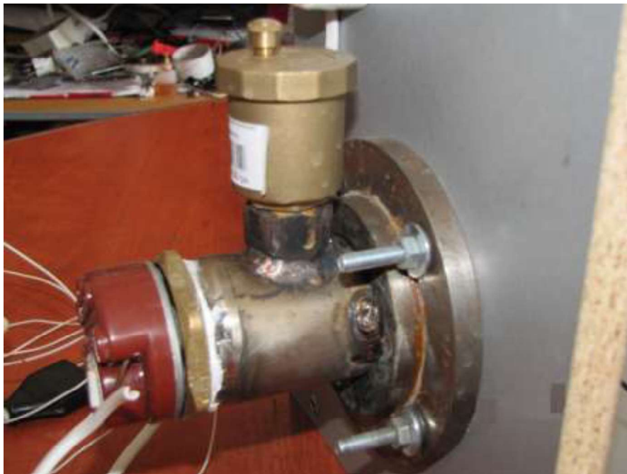
Рисунок 3.2 – Запобіжний клапан в нагрівальній частині стенду
