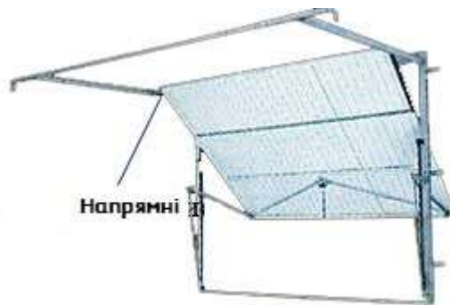
Рисунок 1.18 - Рух ступки у підйомно-поворотних воротах
