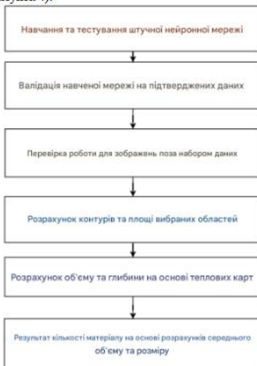
Рис. 4: Загальний принцип створення моделі для виявлення та обчислення вибоїн [12-14]
