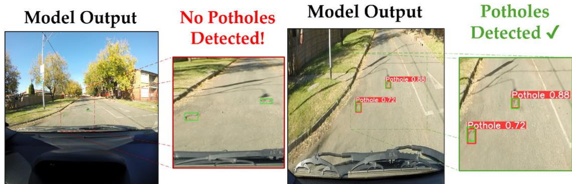
Рисунок 1.2 – Вплив кута фіксації вибоїни на роботу системи розпізнавання [71]
