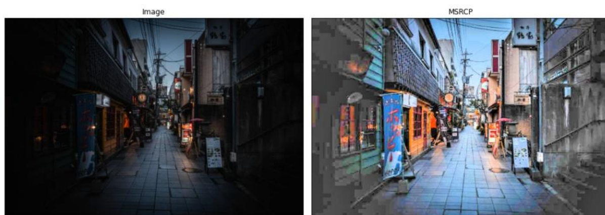
Рисунок 2.6 – Приклад використання Multi Scale Retinex with Color Preservation [86]
